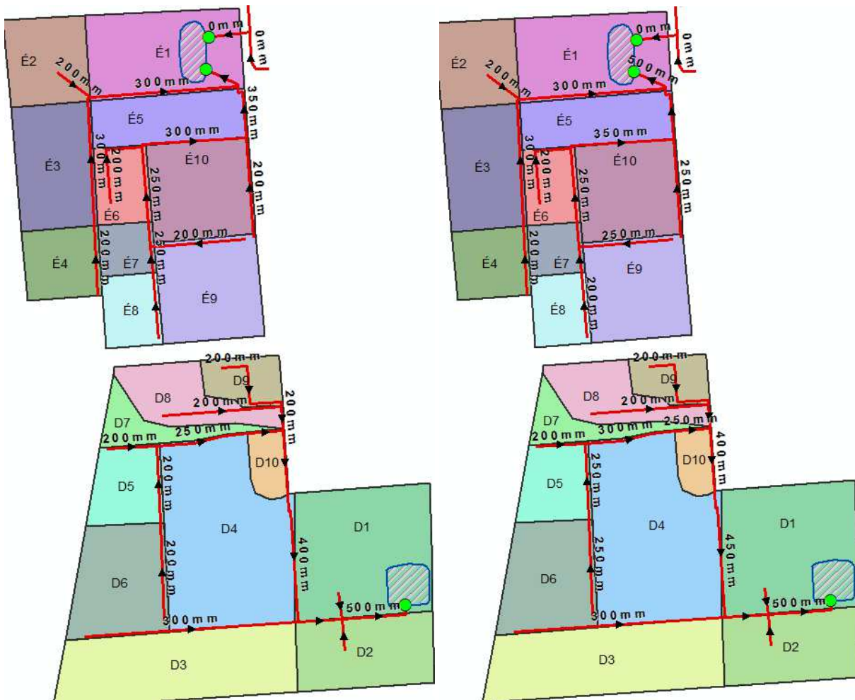
5. ábra A csőhálózat méretezett geometriája 2 éves (baloldal) és 4 éves (jobb oldal) esetben
